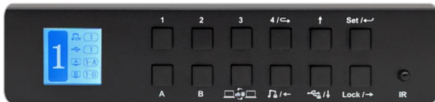
フロントパネルのボタンまたは IR リモコンを使用して KVM を制御すると、LCD ディスプレイがターゲットアクションを照会し、操作に応じてコマンドを実行します。上図の LCD インタフェースは、メインインタフェースです。
