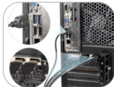
2. 外部のマウスとキーボードをKVMのキーボードおよびマウスの入力ポートに接続します。
