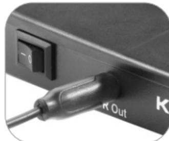
8.電源ケーブルをKVMのDC 5Vポートに接続し、安定したDCを使用して電源ソケットに接続します。
