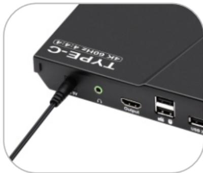
8. Nachdem Sie die obigen Schritte ausgeführt haben, drücken Sie den Netzschalter und Ihr KVM-Switch befindet sich im Betriebszustand.
