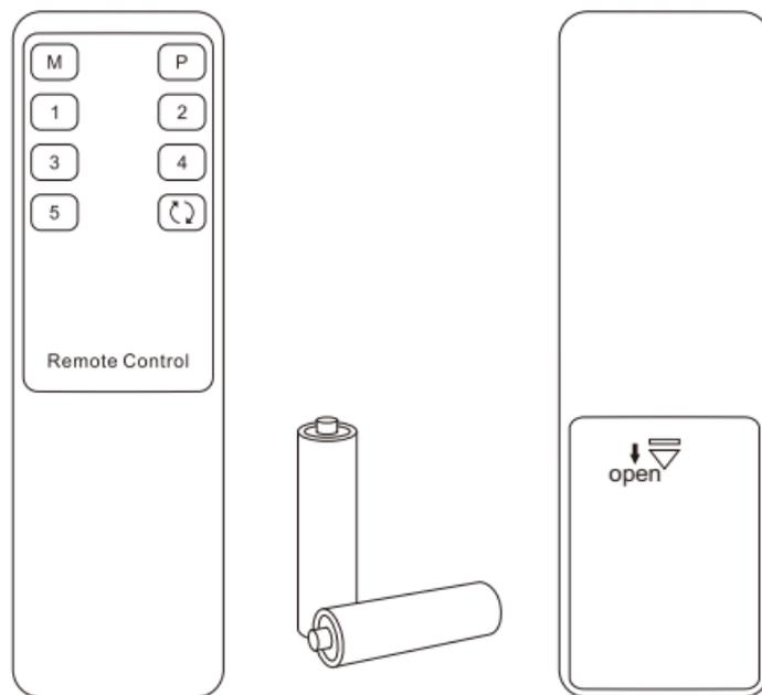
**Tipp:** Aus Sicherheitsgründen ist die Fernbedienung standardmäßig nicht mit einer Batterie ausgestattet. Bitte setzen Sie die AAA-Batterie bevor Sie das Produkt verwenden (siehe unten).
